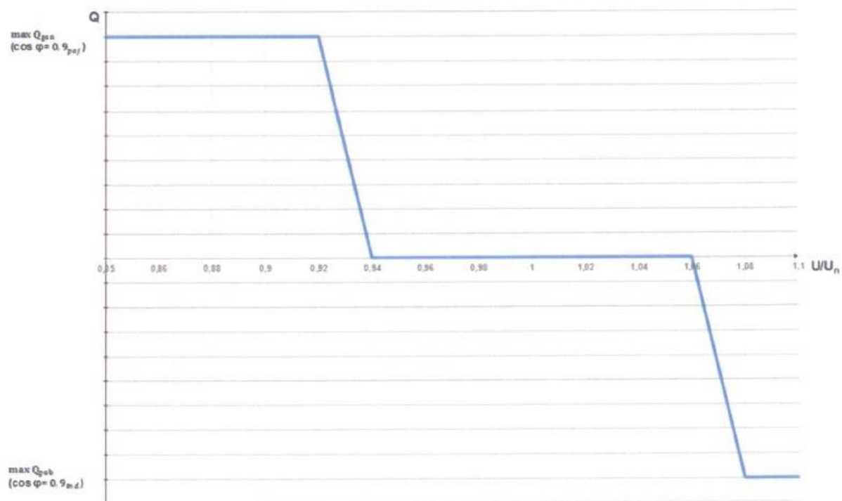
Rys.3. Charakterystyka sterowania mocą bierną w funkcji napięcia wymagana przez OSDnn.
