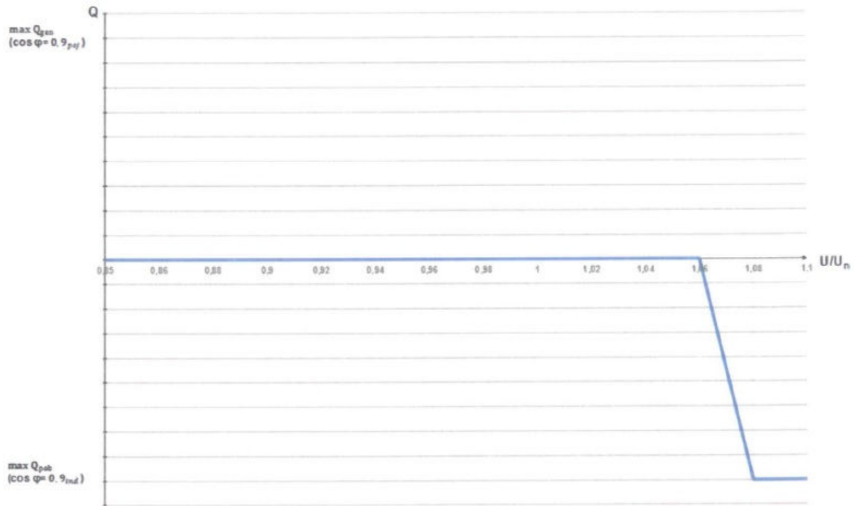
Rys.4. Charakterystyka sterowania mocą bierną w funkcji napięcia dla mikroinstalacji podłączonych jednofazowo, wymagana przez OSDnn.
